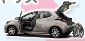
●車いす収納装置付車 タイプII (運転席&助手席ターンチルトシート付)
