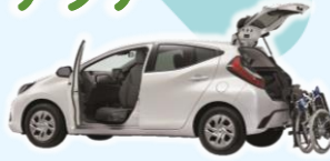
●車いす収納装置付車 (助手席ターンチルトシート付)
