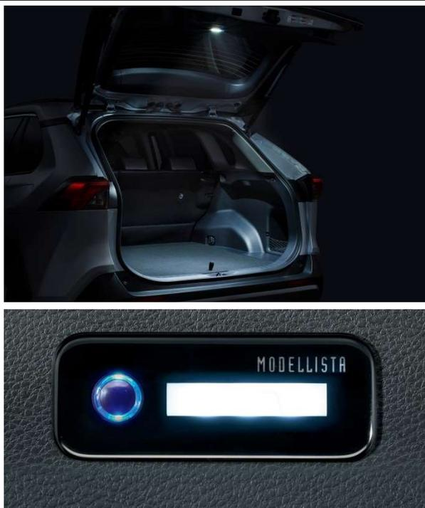
スマートなデザインの中にバックドアの開閉と連動して光る LED を 3 灯搭載し、夜間の使い勝手を向上させます。
